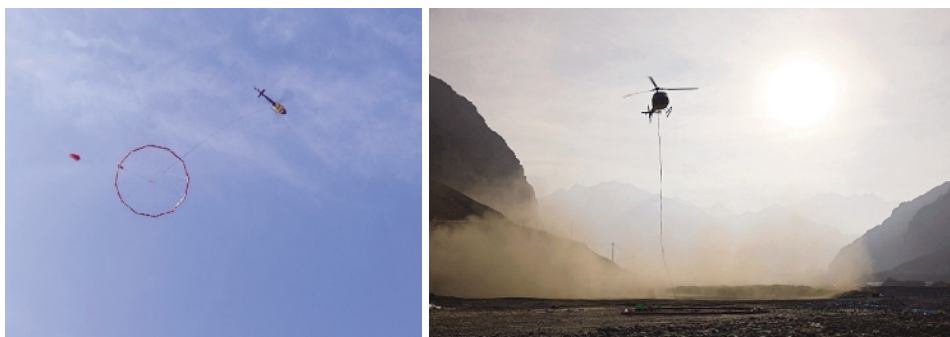
航空大地电磁探测系统实施飞行探测作业。 空天院供图
