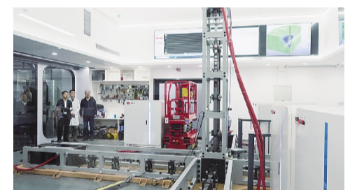
动态真三轴电磁霍普金森杆试验测试系统。深圳大学供图
