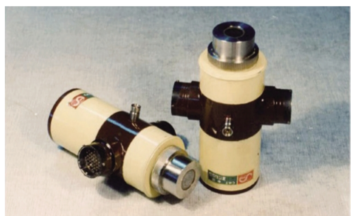
60像元长波红外探测器。
