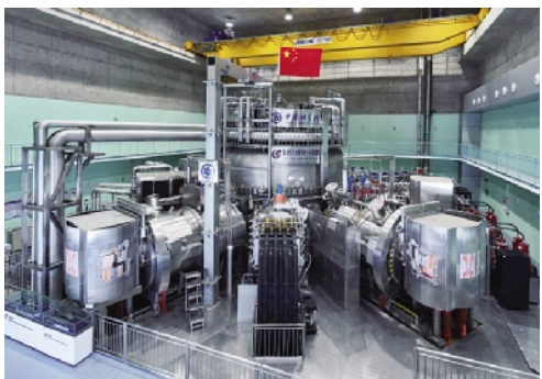
世界首台非圆截面全超导托卡马克实验装置 EAST。
